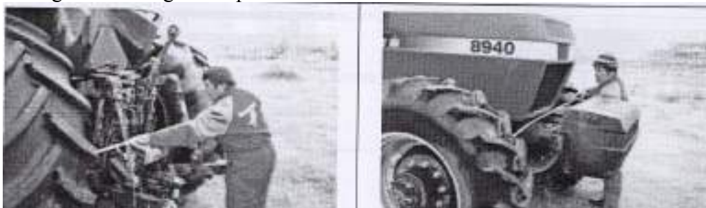
2-rasm. Orqa va oldingi g'ildiraklar orasidagi masofani o'lchash.
