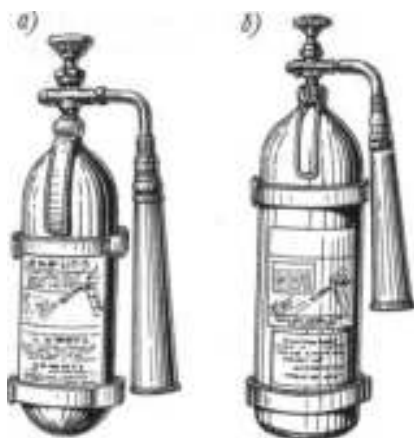
3-rasm. Uglekislotali o't o'chirgichlar: a) -OU-2; b) – OU-5
