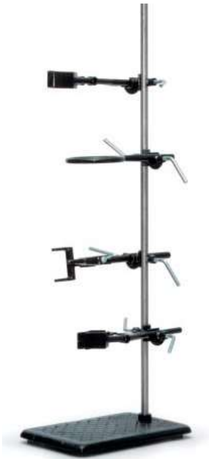
31- rasm. Laboratoriya shtativi. 1— qisqichlar; 2—tagliklar.
