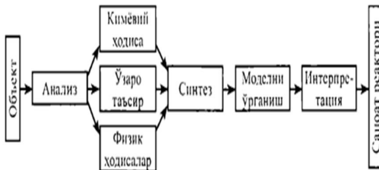
2.5-расм. Реакторлар ва кимёвий жараёнларни математик моделлаш схемаси.
