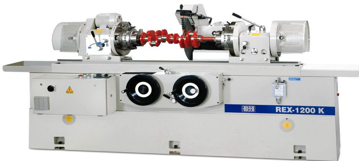
4.2-rasm. Tirsakli vallarni ta'mir o'lchamlariga tiklash dastgohi
