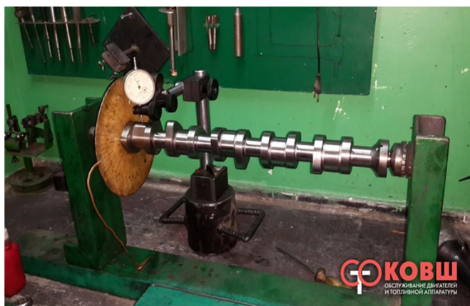
10.2- rasm. Taqsimlash valning tayanch bo'yin (a) va kulachoklarini (б, в) o'lchash sxemasi.
