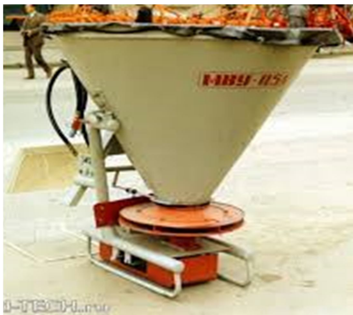
4.3-rasm. MVU-0,5 mineral o'g'itlarni sepadigan mashinasi
