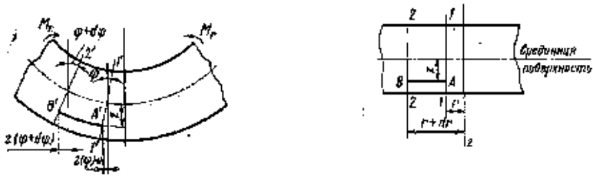
24-rasm. Tsilindrsimon plastinaning har xil qalinlikdagi qirqimida burchak siljishi tasvirlangan.
