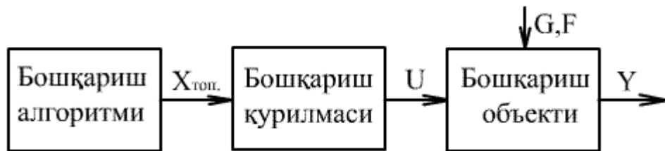
4.2-rasm. Ochiq sikl bo'yicha ABS ning funksional sxemasi
