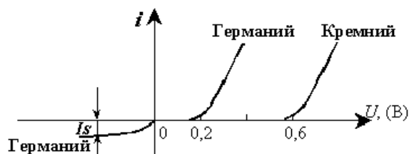
2.3-расм. Германийли ва кремнийли ясси диоднинг волт-ампер характеристикаси
