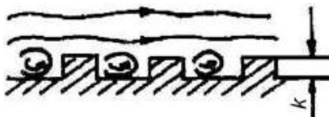
4.7-rasm. S/k ning kichik qiymatlarida sun'iy uzlukli g'adir-budirlikni yuvilish sxemasi.
