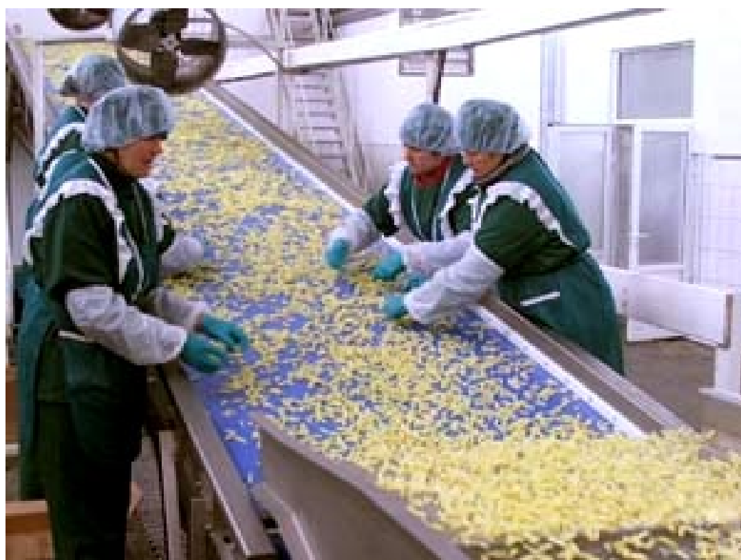
13-rasm. Karam tuzlashda maydalangan mahsulotni tozalash jarayoni
