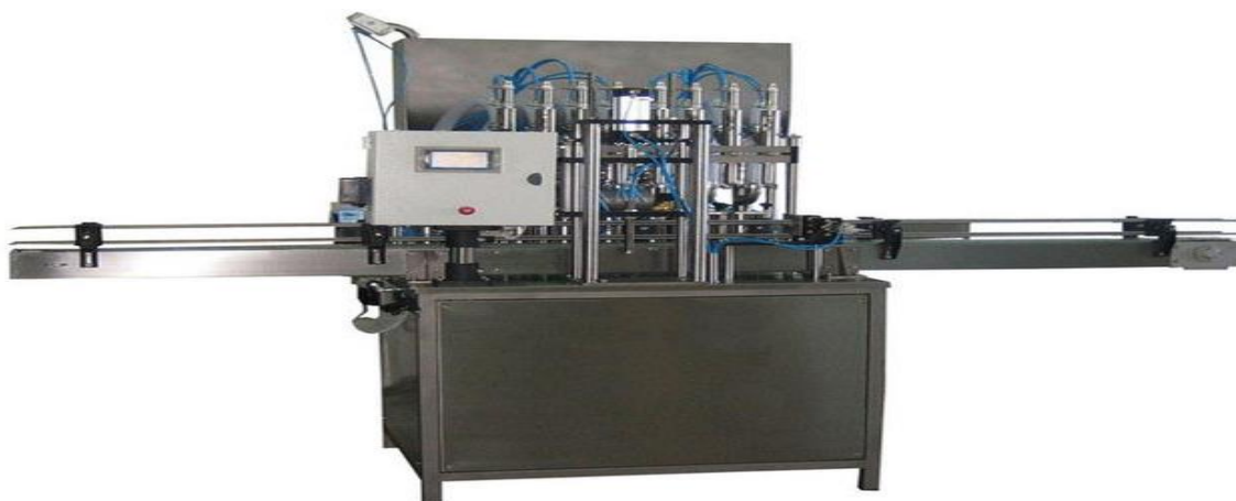
28-rasm. A-05 shisha idishlarga mahsulotlarni me'yorlab quyuvchi mashinasi
