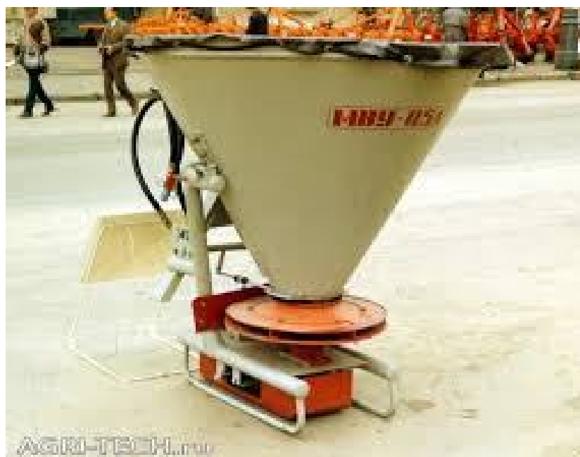
2-rasm. MVU-0,5 mineral o'g'itlarni sochuvchi mashinasi
