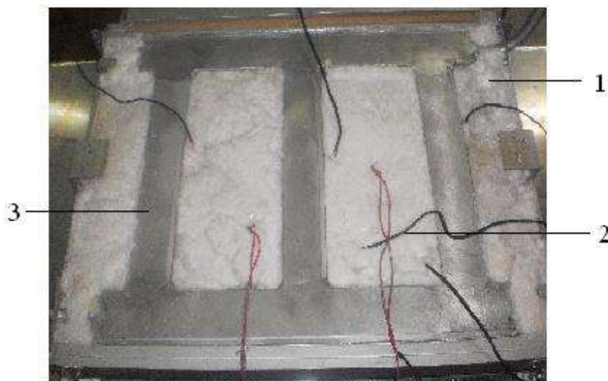
5-rasm. Sovituvchi rezervuar va issiqlik izolyasion materialni joylashtirish tartibi
