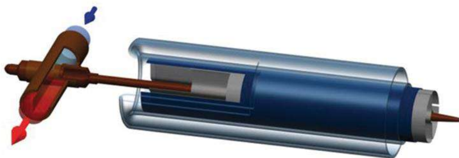
11-rasm. Issiqlik trubkasi ‘ Issiqlik trubkasi ‘ silindrli absorber bilan
