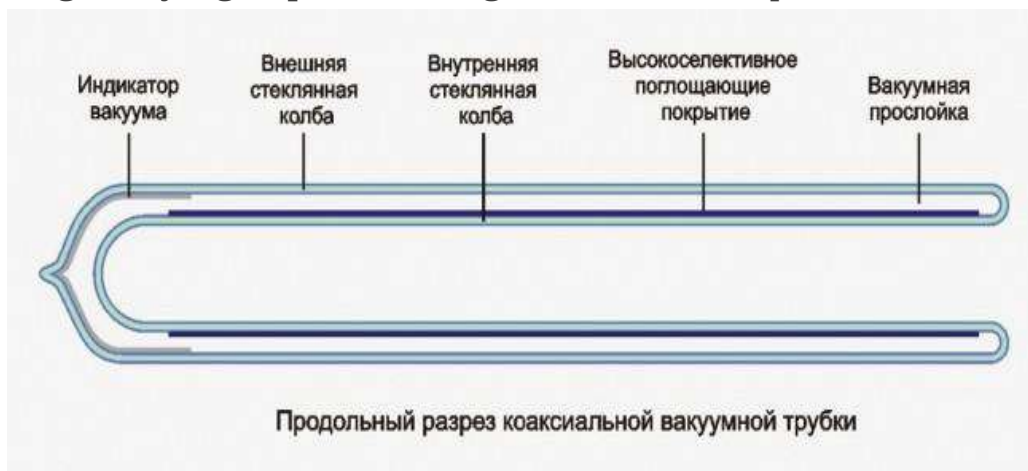
1-rasm. Quyosh kollektorining ingichka devorli vakuum trubkasini qurish
