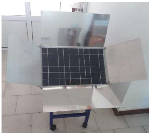
7-rasm. Kombinatsiyalashgan gibrid foto-termoelektrik qurilmasining umumiy ko‘rinishi
