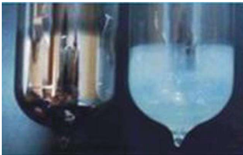
2-rasm. Quyosh kolbalarida vakuum darajasining ko'rsatkichi
