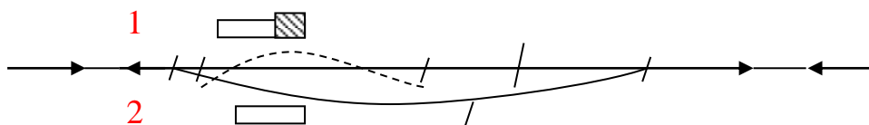
8.1-расм. Бир томонлама темир йўлда ўтказиб юбориш станцияси схемаси. 1-асосий йўл; 2-ёнлама йўл.
