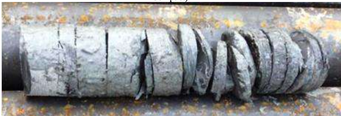
1.5-rasm. Kern oluvchi ichki quvurini qiyshayishi va egilishi natijasida yorilib ketgan kern
