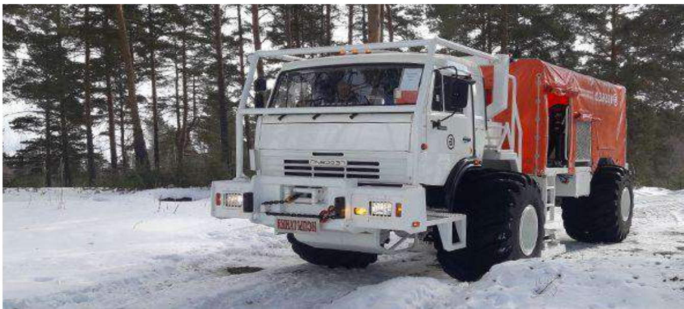
7.2-rasm. Neft va gazni yer usti seysmorazvedkasi uchun seysmik signallar vibratsiya manbai.
