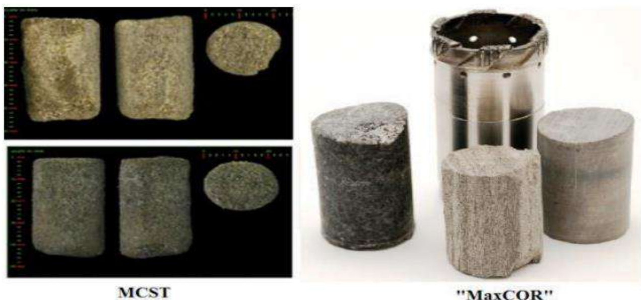
1.3-rasm. MCST (namuna diametric 1 dyum) va MaxCOR (namuna diametric 1,5 dyum) tizimlari bilan burg'ilangan kern namunalari
