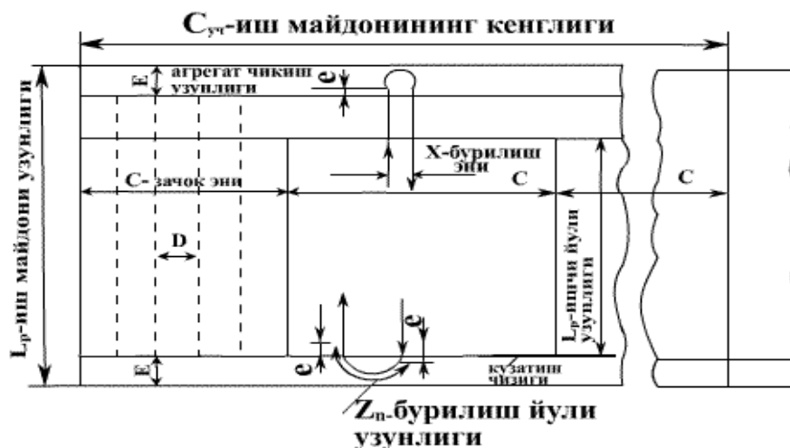
1-rasm. Agregatning ish uchastkasi sxemasi.
