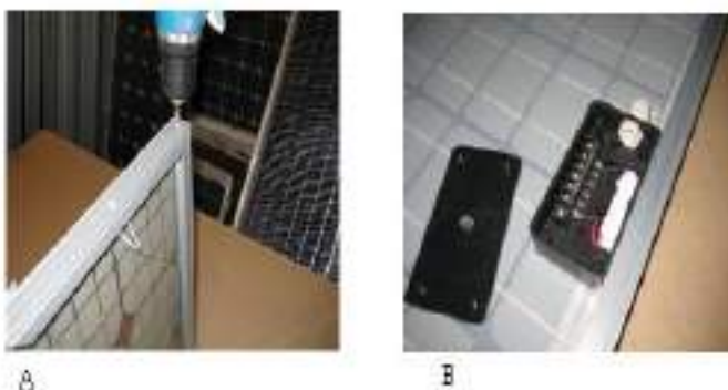
44-rasm. A-alyuminiy karkasni montaj qilish; B-klemmali qutini o'rnatish
