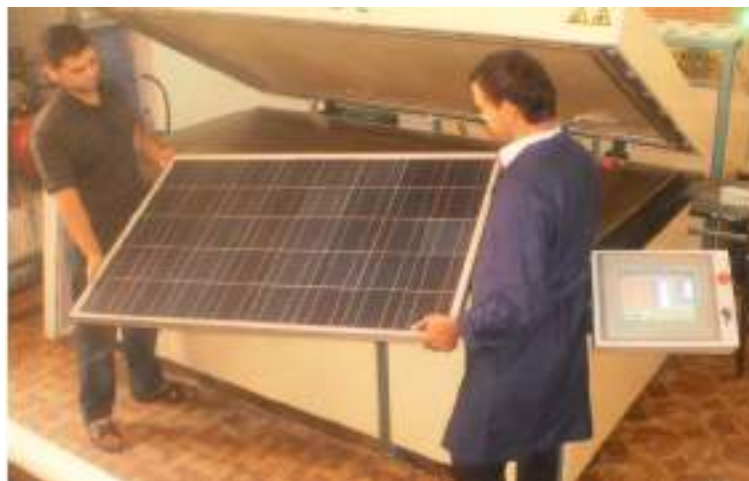
42-rasm. Fotoelektrik modul laminatsiya pechidan so'ng
