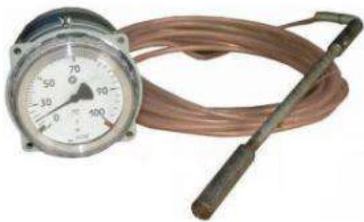
3.10-rasm. TGP-100Ek-M1 rusumli elektrokontaktli gazli manometrik ko'rsatuvchi termometr
