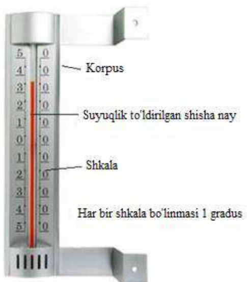
3.1-rasm. Suyuqlikli termometrning tuzilishi.
