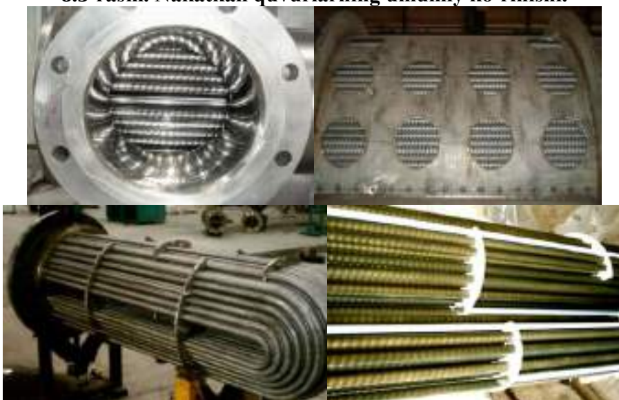
8.4-rasm. HRS Group (Ispaniya) korporatsiyasining profillangan quvurli issiqlik almashinuv qurilmalarining konstruksiyalari.
