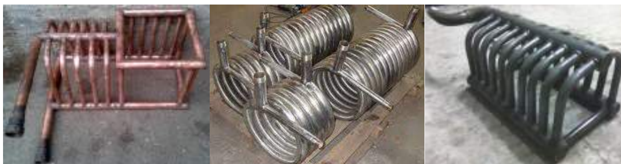
6.6-rasm. Tutun gazi yordamida isitish qurilmasi va uning issiqlik almashinuv elementlari.
