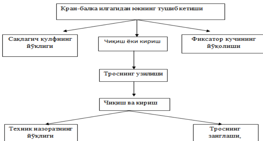
2-rasm. «Xavflar daraxti»ning sxemasi.
