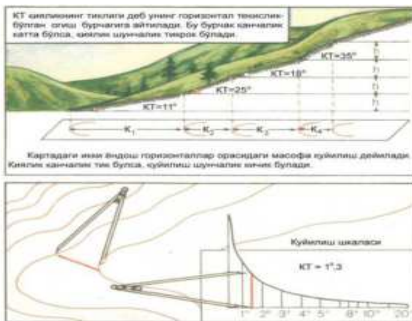
42-rasm. Quyilish shkalasi bo'yicha qiyalik tikligini aniqlash
