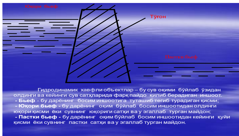
1-rasm. To'g'on qismlariga tushadigan suv bosimi
