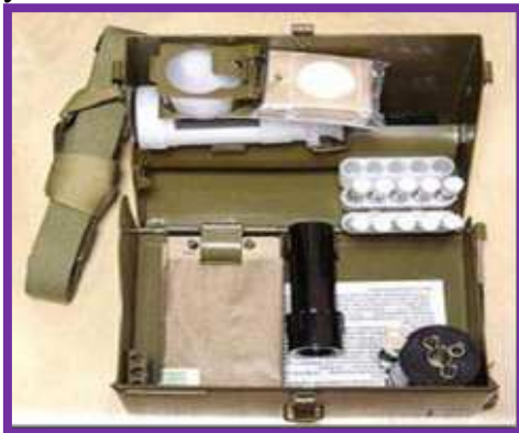
2- rasm Kimyoviy razvedka harbiy asbobi (VPXR) Kimyoviy razvedka harbiy asbobi (VPXR) - havoda, yer yuzasida, sochiluvchi materiallar va tutunda zaharlovchi moddalar borligini aniqlashga mo'ljallangan.
