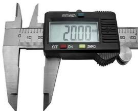
Elektron shtangentsirkul yordamida chiziqli kattaliklarni o'lchash
