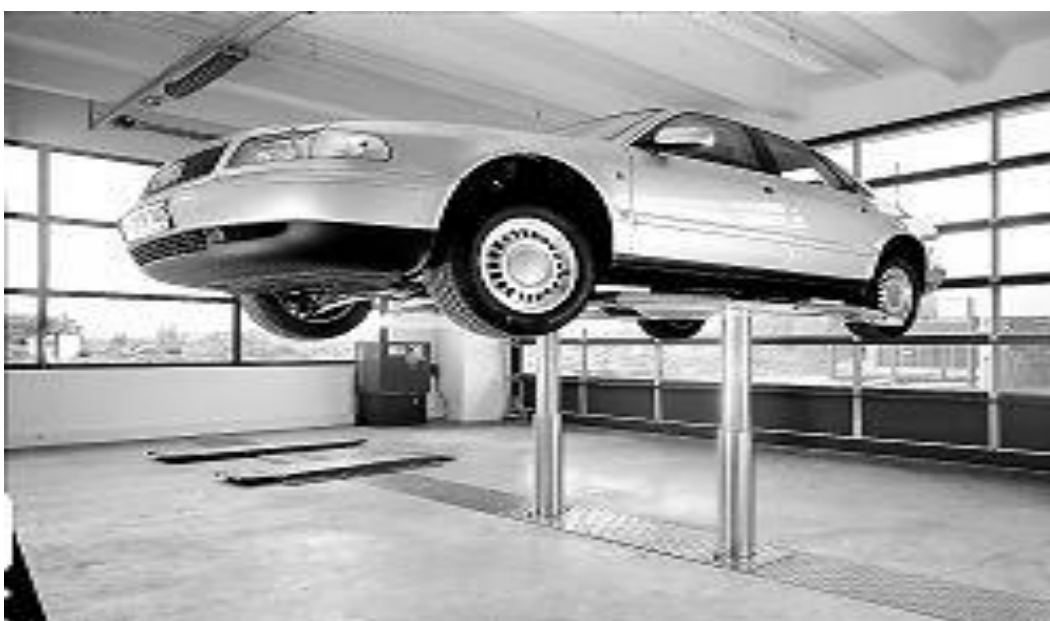
12-rasm. Ikki ustunli fermali (a), to'rt ustunli elektro-mexanik (b) va ikki ustunli gidravlik (v) ko'targichlar.
