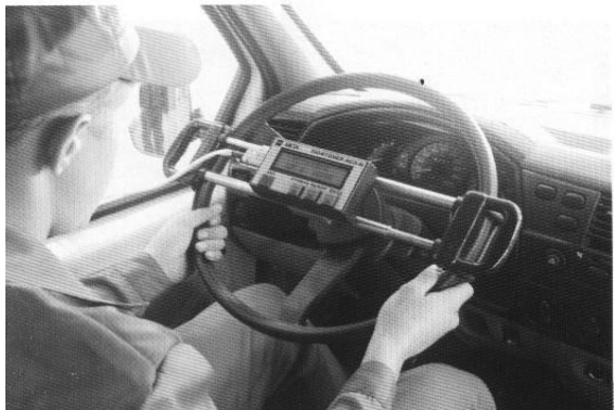
32-rasm. Rul boshqarmasining umumiy lyuftni aniqlash uchun ISL-M jihozi.
