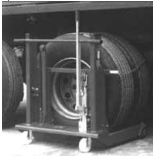
17-rasm. Avtomobillar g’ildiraklarini yechib olish, o’rnatish va transportirovkalash uchun aravacha. a- umumiy ko’rinishi; b- ish jarayonida.
