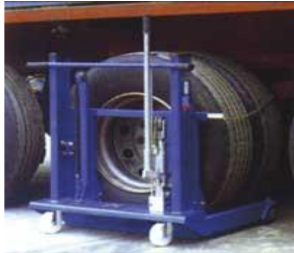
2.6-rasm. Avtomobillar g'ildiraklarini yechib olish, o'rnatish va transportirovkalash uchun aravacha.
