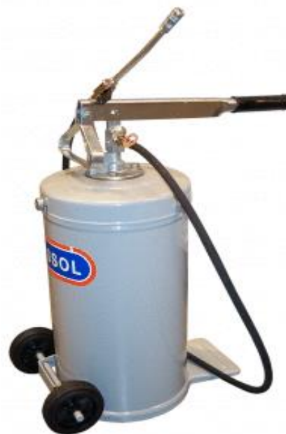
2.4-rasm. Qo'zg'almas suyuq (a) va qo'zg'aluvchan (b) quyuc moy tarqatuvchi moslamalar
